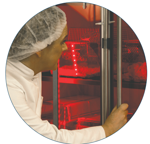
Rotes LED-Licht wird für eine problemlose Inspektion bei "Nacht" und weißes LED-Licht für die Simulation des "Tages" im ScanTainer verwendet
